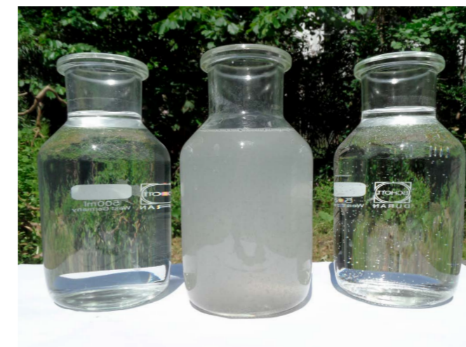
Aufbereitetes Grauwasser Grauwasser vor der Aufbereitung Trinkwasser
